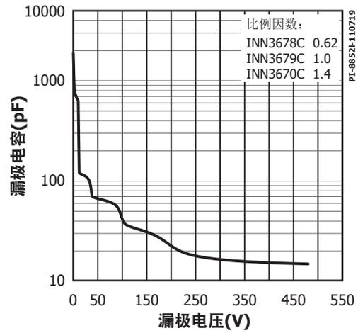
图38.  $C_{oss}$  相对于漏极电压的变化
