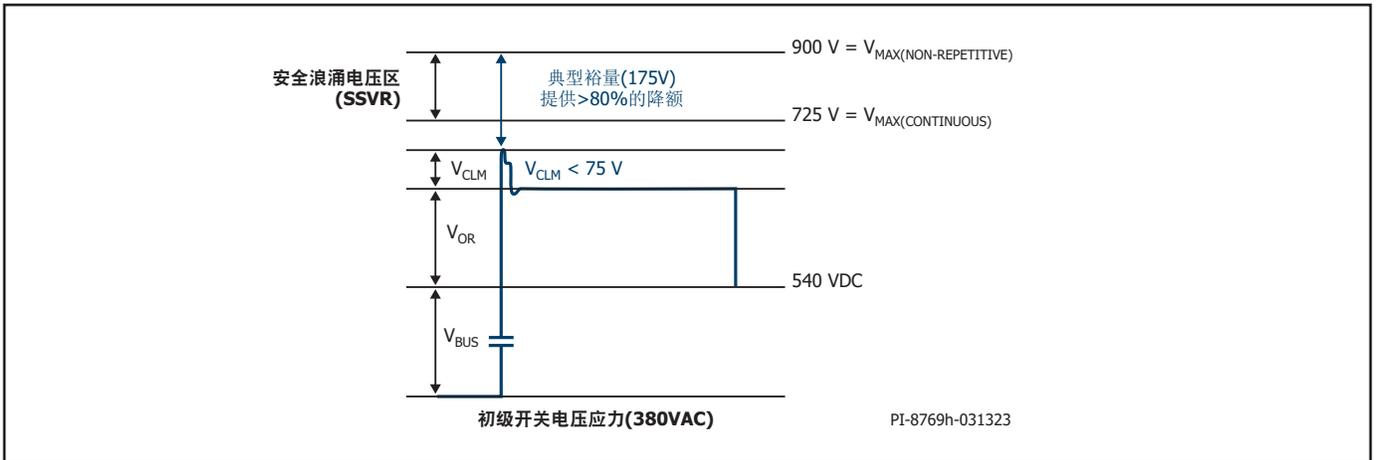
图23. 使用900V PowiGaN开关时380VAC输入电压下的峰值漏极电压
