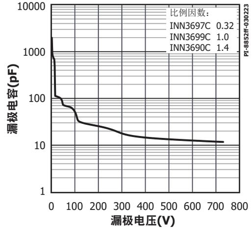
图42.  $C_{OSS}$  相对于漏极电压的变化
