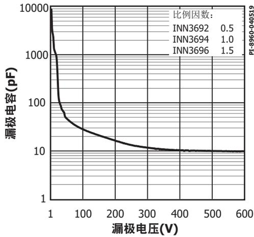
图34.  $C_{OSS}$  相对于漏极电压的变化
