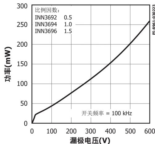
图35. 漏极电容功率
