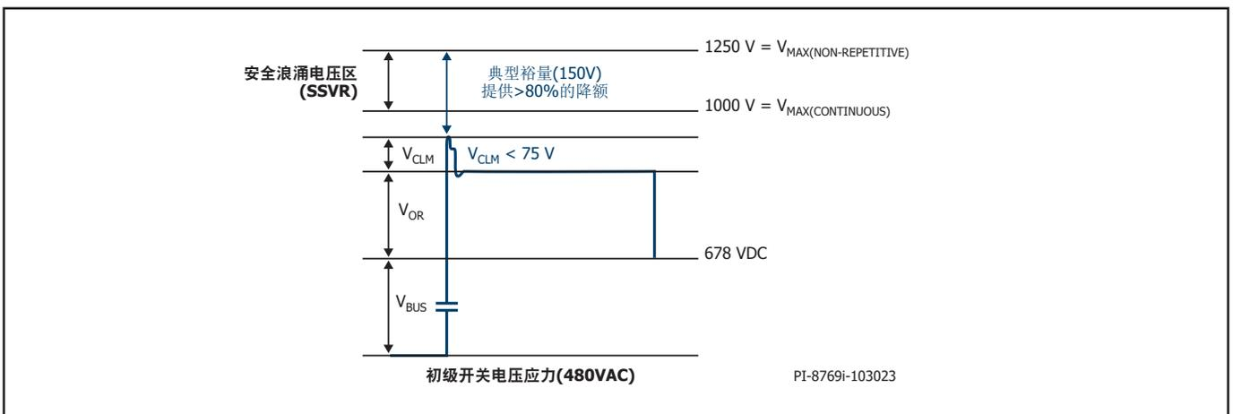
图24. 使用1250V PowiGaN开关时480VAC输入电压下的峰值漏极电压
