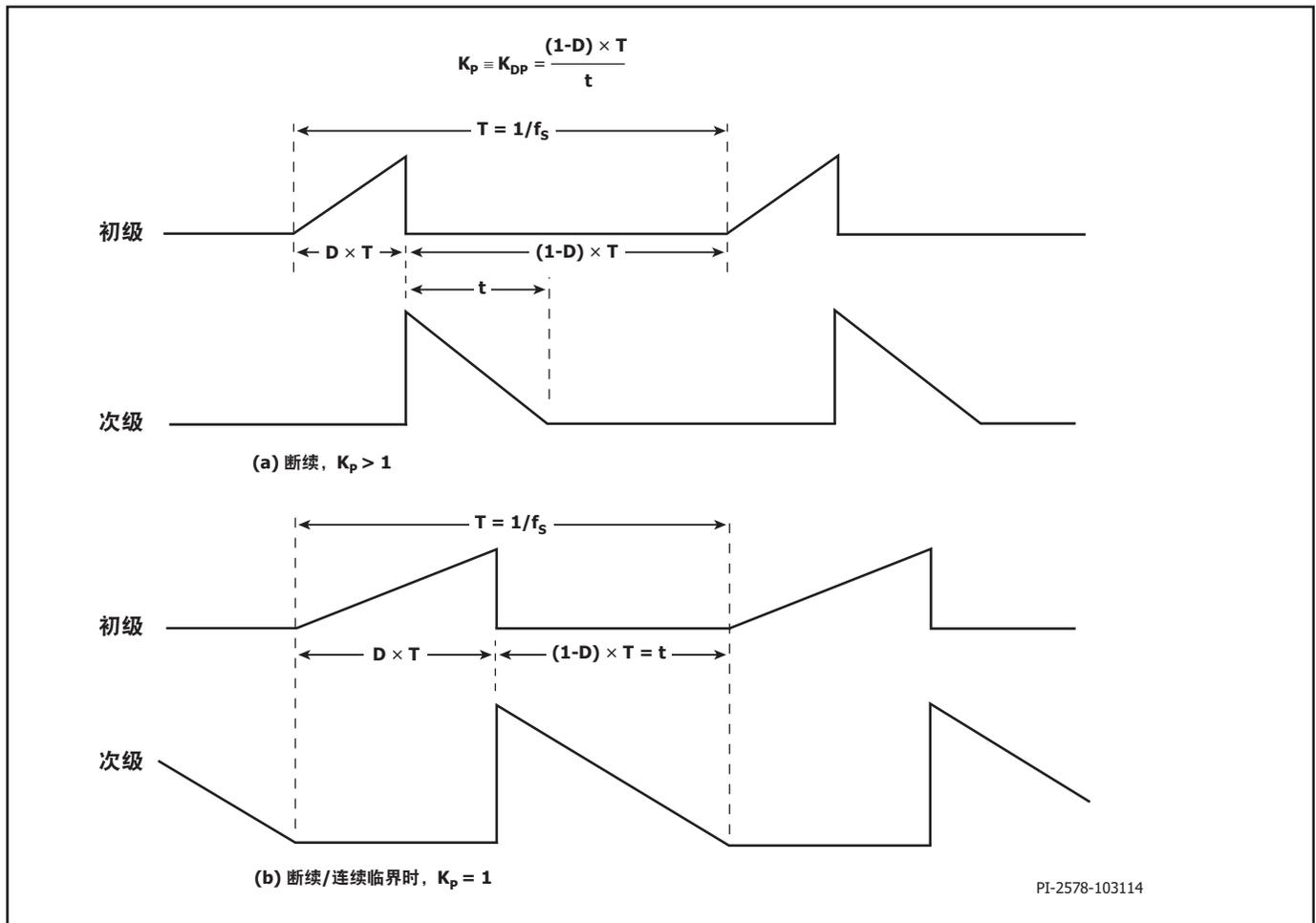
图21. 断续导通模式电流波形,  $K_p > 1$
