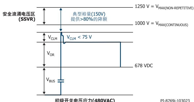
图24. 使用1250V PowiGaN开关时480VAC输入电压下的峰值漏极电压
