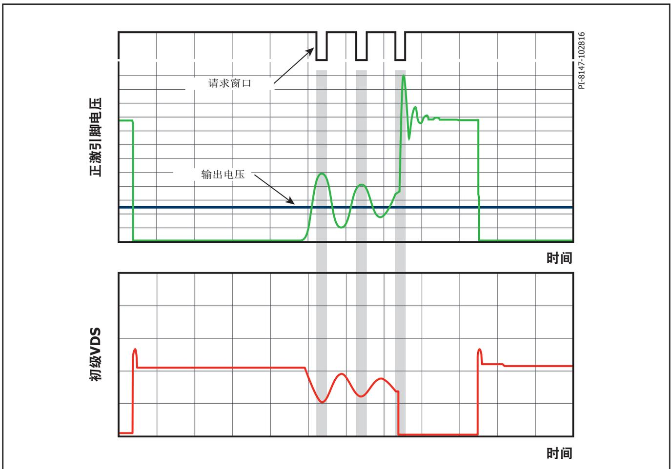
图8. 智能准谐振模式开关工作
