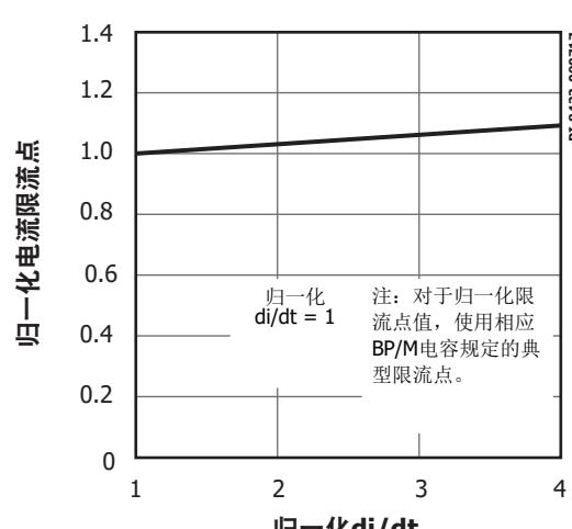
图31. 标准限流点相对于di/dt的变化
