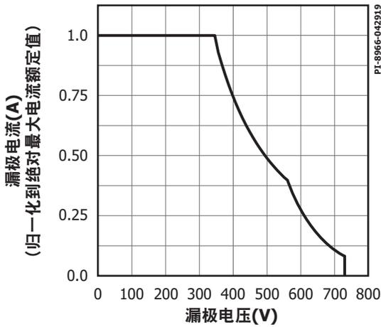
图26. 最大允许的漏极电流相对于漏极电压的变化 (INN3672-INN3677)
