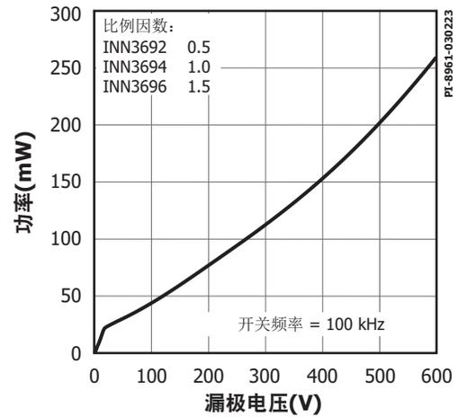
图35. 漏极电容功率
