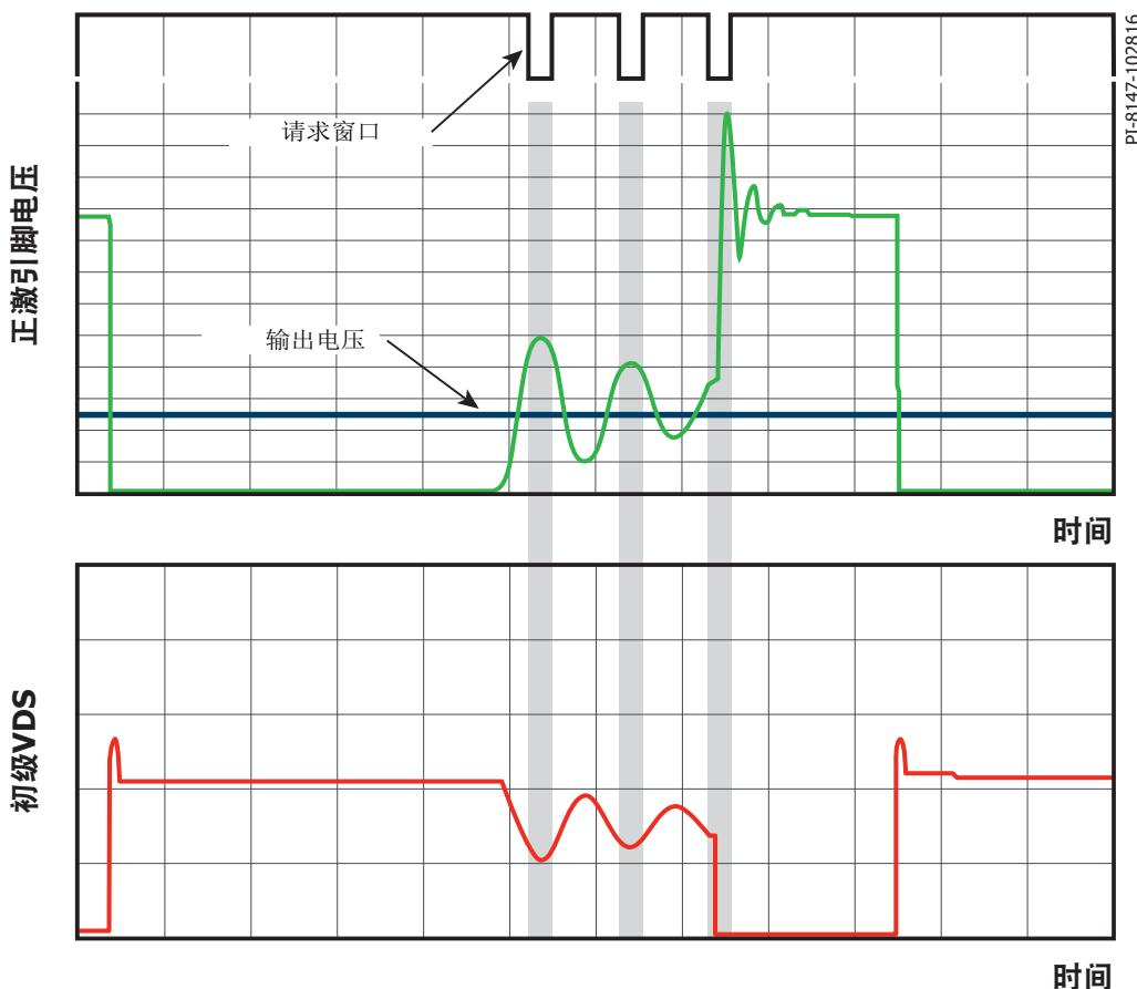
图8. 智能准谐振模式开关工作
