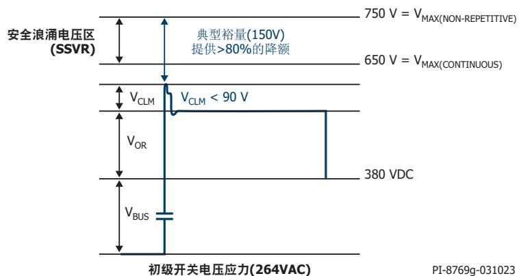
图22. 使用750V PowiGaN开关时264VAC输入电压下的峰值漏极电压
