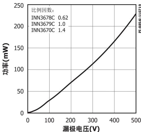
图39. 漏极电容功率
