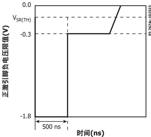
图30. 正激引脚负电压限值
