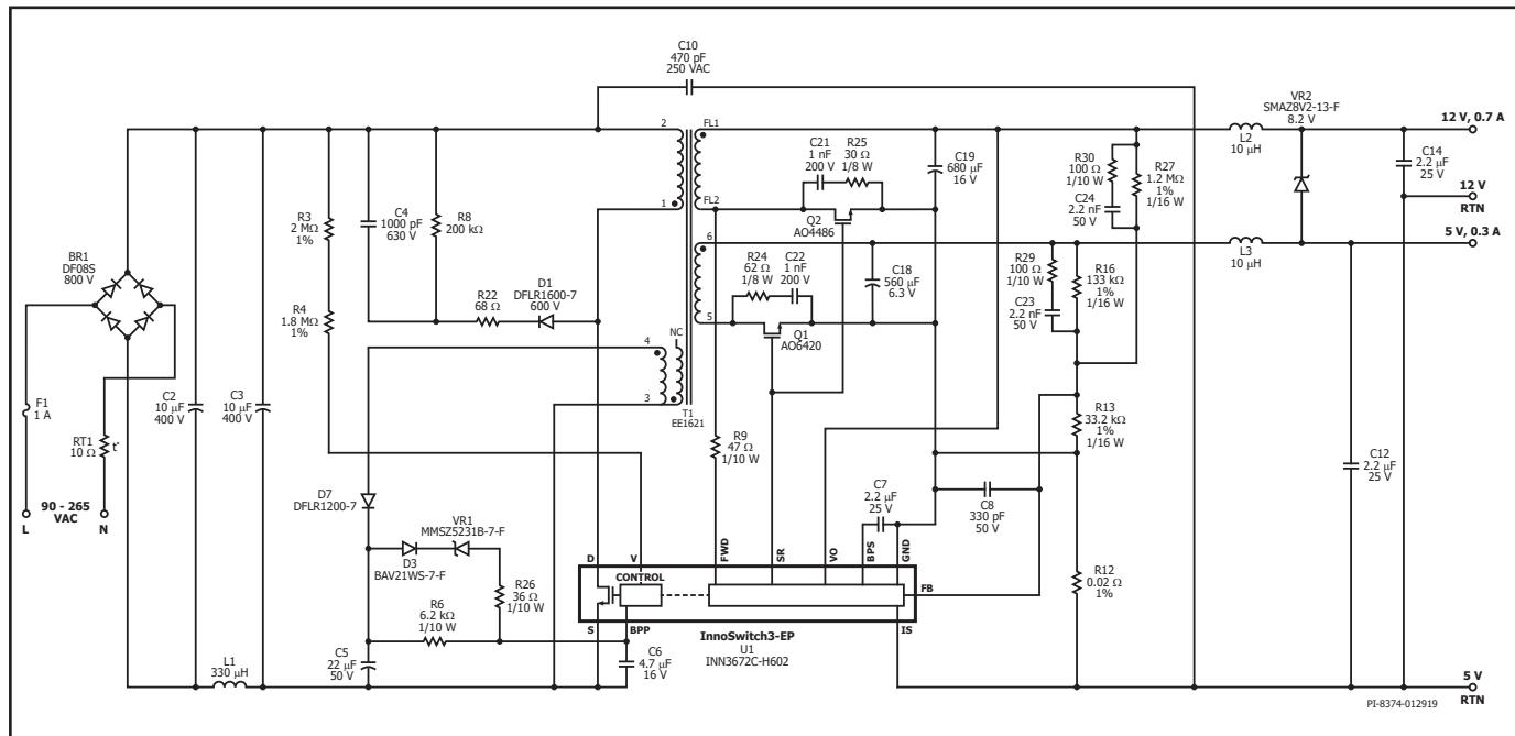
图10. DER-611电路原理图 - 5V/0.3A和12V/0.7A电源, 适合HVAC (暖通空调) 应用
