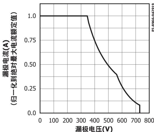
图26. 最大允许的漏极电流相对于漏极电压的变化
