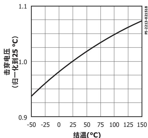
图36. 击穿电压相对于温度的变化 (不包括INN3678C/INN3679C/
