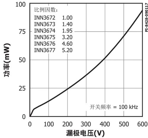
图29. 漏极电容功率
