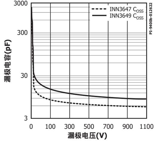
图46.  $C_{oss}$  相对于漏极电压的变化
