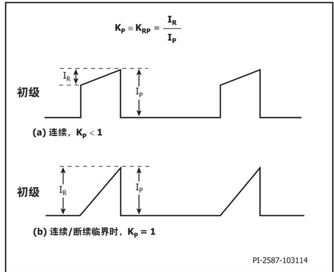
图20. 连续导通模式电流波形,  $K_p < 1$
