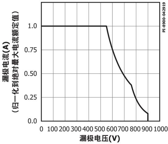
图32. 最大允许的漏极电流相对漏极电压的变化(INN369x)
