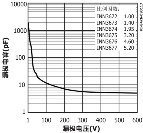
图28.  $C_{oss}$  相对于漏极电压的变化
