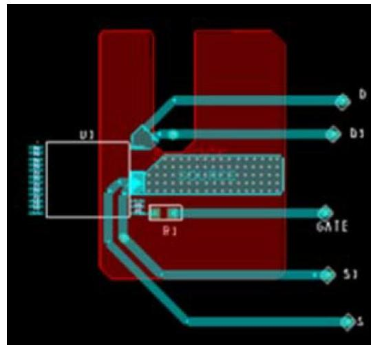
图25. PowiGaN器件（INN3678C、INN3679C和INN3670C）的热阻测试条件
