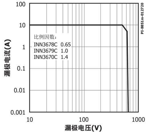
图40. 最大允许的漏极电流相对于漏极电压的变化
