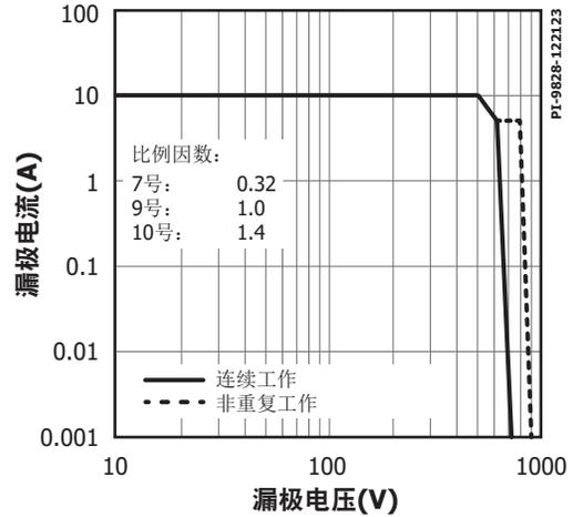
图44. 最大允许的漏极电流相对于漏极电压的变化 (PowiGaN器件INN3697C/INN3699C/INN3690C)
