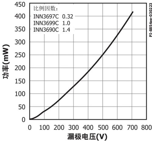
图43. 漏极电容功率
