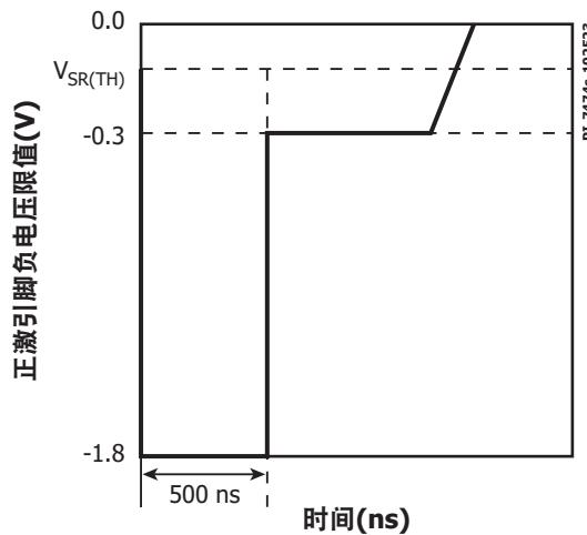
图30. 正激引脚负电压限值
