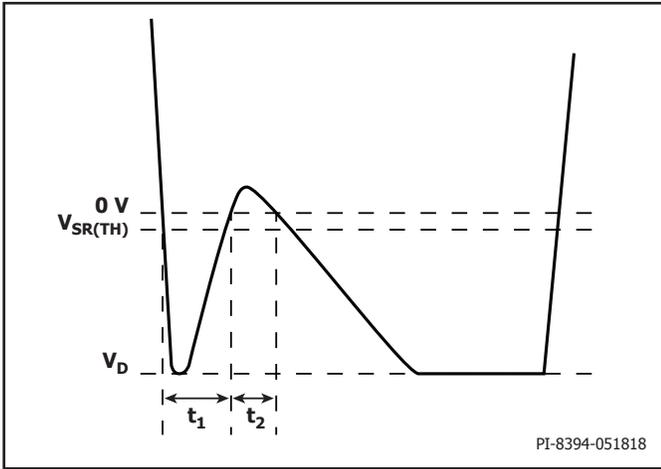
图15. 握手前反激周期中体二极管导通期间不可接受的正激引脚电压波形注:
