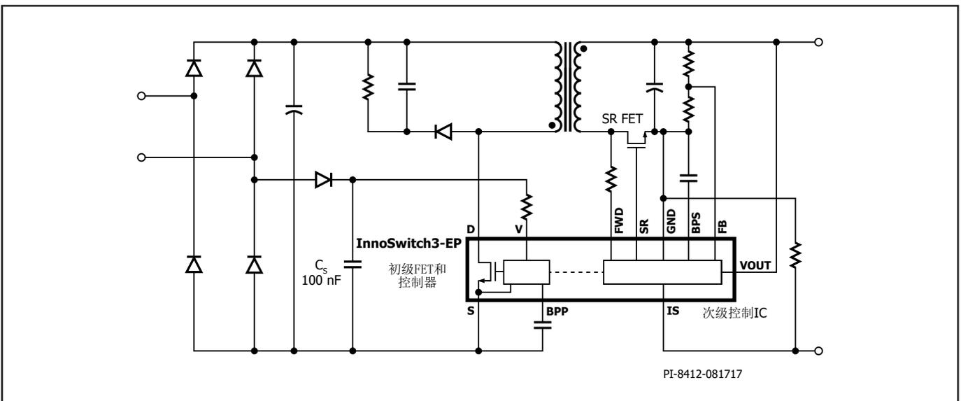
图18. 快速AC复位电路配置
