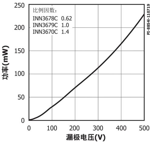
图39. 漏极电容功率
