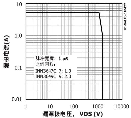
图48. 最大允许的漏极电流相对于漏极电压的变化
