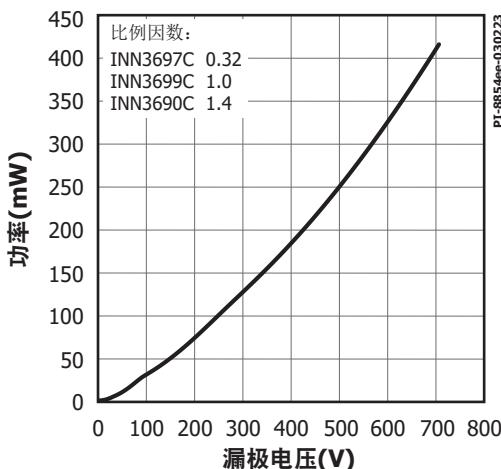
图43. 漏极电容功率
