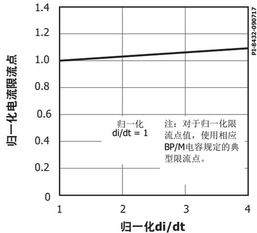
图31. 标准限值点相对于di/dt的变化
