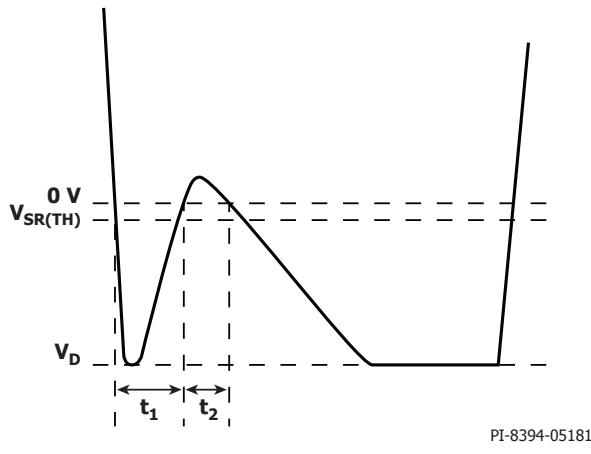
图15. 握手前反激周期中体二极管导通期间不可接受的正激引脚电压波形
