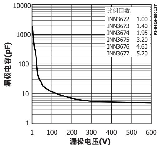
图28. C<sub>oss</sub>相对于漏极电压的变化
