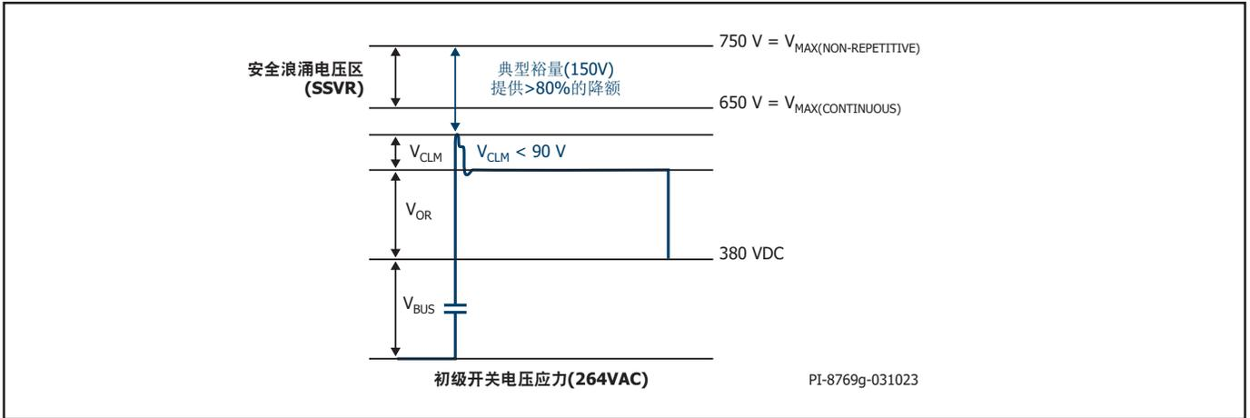
图22. 使用750V PowiGaN开关时264VAC输入电压下的峰值漏极电压
