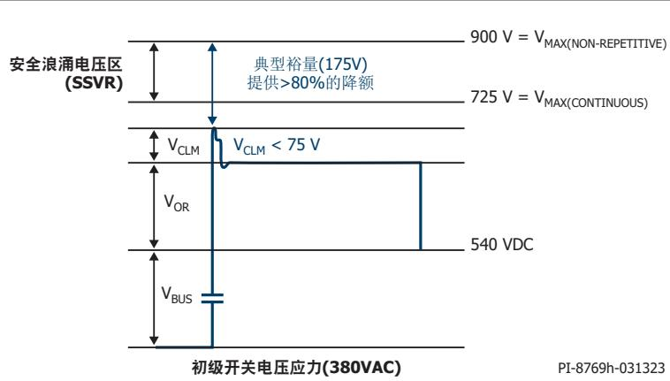
图23. 使用900V PowiGaN开关时380VAC输入电压下的峰值漏极电压
