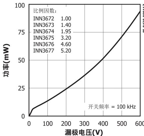
图29. 漏极电容功率
