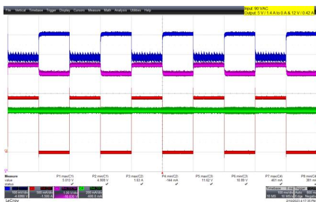
图75 - 0A - 0.42A, 5V负载阶跃动态响应, 90 VAC 5V MAX : 5.01V; 5V MIN : 4.81V 12V MAX : 11.62V; 12V MIN : 10.89V 上: 5V OUT , 100mV/格 上中: 5I OUT , 500mA/格 下中: 12V OUT , 1V/格 下: 12I OUT , 200mA/格 100ms/格
