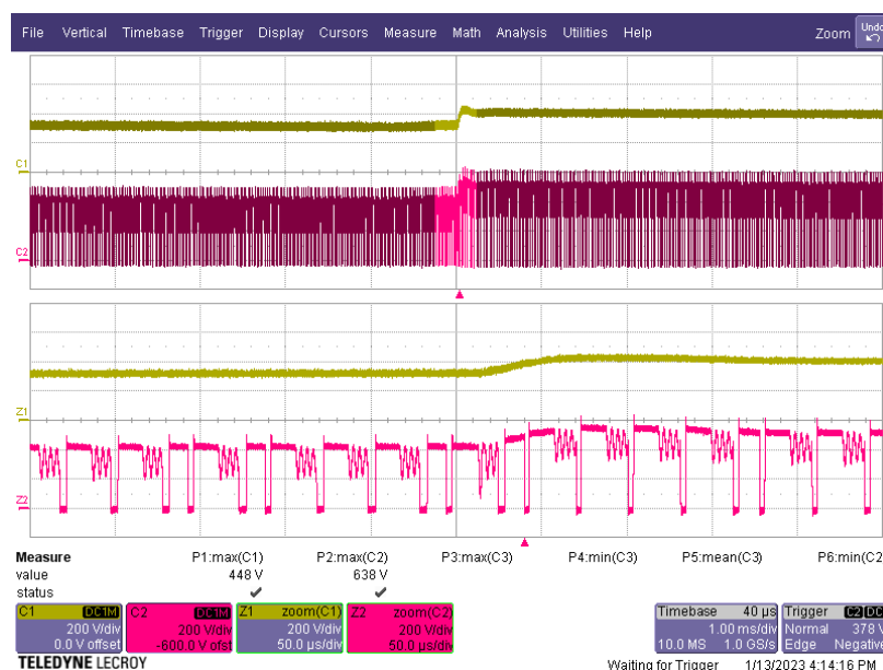
图148 - 230VAC, +1kV, 差模浪涌, L-N
