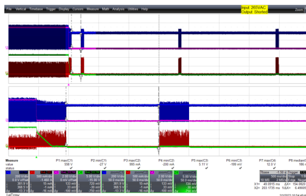
图104 - 输出电压和电流波形 265VAC输入输出短路 上: LNK-XT2SR_V Ds 200V/格 上中: 5V OUT , 1V/格 下中: 12V OUT , 5V/格 下: LNK-XT2SR_I Ds , 500mA/格 500ms/格 缩放: 50ms/格
