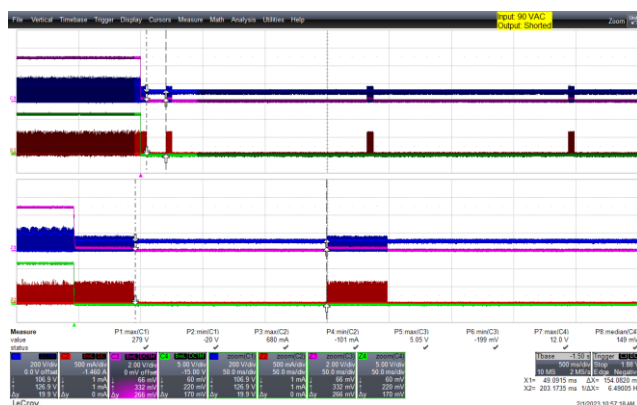
图105 - 输出电压和电流波形 90VAC输入输出短路 上: LNK-XT2SR_V Ds 200V/格 上中: 5V OUT , 1V/格 下中: 12V OUT , 5V/格 下: LNK-XT2SR_I Ds , 500mA/格 500ms/格 缩放: 50ms/格
