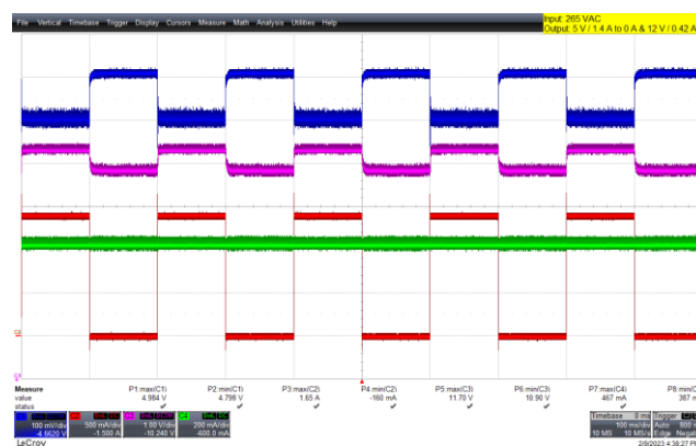
图76 - 0A - 0.42A, 5V负载阶跃动态响应, 265 VAC 5V MAX : 4.98V; 5V MIN : 4.80V 12V MAX : 11.70V; 12V MIN : 10.9V 上: 5V OUT , 100mV/格 上中: 5I OUT , 500mA/格 下中: 12V OUT , 1V/格 下: 12I OUT , 200mA/格 100ms/格
