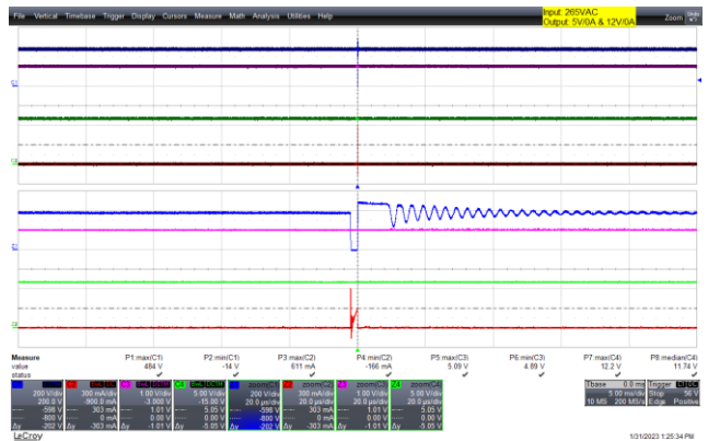
图82 - 漏极电压和电流波形 265VAC输入，空载，(484V MAX ) 上：LNK-XT2SR_V DS 200V/格 上中：5V OUT ，1V/格 下中：12V OUT ，5V/格 下：LNK-XT2SR_I DS ，300mA/格 5ms/格 缩放：20μs/格
