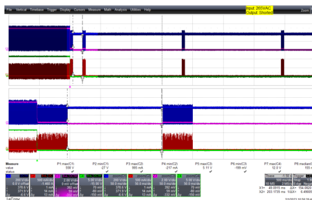
图106 - 输出电压和电流波形 265VAC输入输出短路 上: LNK-XT2SR_V Ds 200V/格 上中: 5V OUT , 1V/格 下中: 12V OUT , 5V/格 下: LNK-XT2SR_I Ds , 500mA/格 500ms/格 缩放: 50ms/格
