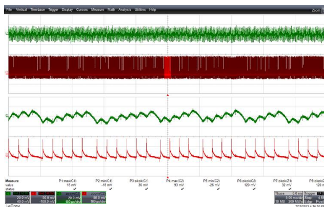
图126 - 输出纹波电压波形 265VAC输入 5V PK-PK : 36mV, 12V PK-PK : 120mV 上: 5V OUT , 20mV/格, 5ms/格 下: 12V OUT , 50mV/格, 5ms/格 缩放: 100µs/格
