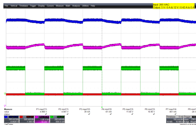
图74 - 0A - 0.42A, 12V负载阶跃动态响应, 265 VAC 5V MAX : 4.98V; 5V MIN : 4.94V 12V MAX : 11.4V; 12V MIN : 10.9V 上: 5V OUT , 100mV/格 上中: 5I OUT , 500mA/格 下中: 12V OUT , 1V/格 下: 12I OUT , 200mA/格 100ms/格
