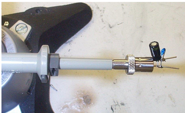
图108 - 附加Probe Master ( www.probemaster.com ) 4987A适配器的示波器探头。 （改用导线进行纹波测量，并添加两个并联的去耦电容）
