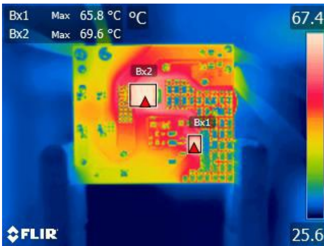
图14 – LNK3209D (Bx1), 65.8°C 降压二极管(Bx2), 69.6°C 85 VAC, 800mA 输出
