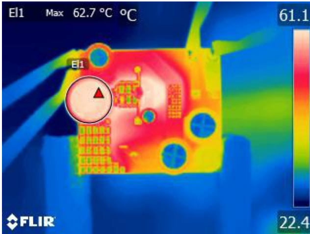
图12 – 降压扼流圈(E1), 62.7°C 85 VAC, 800mA输出
