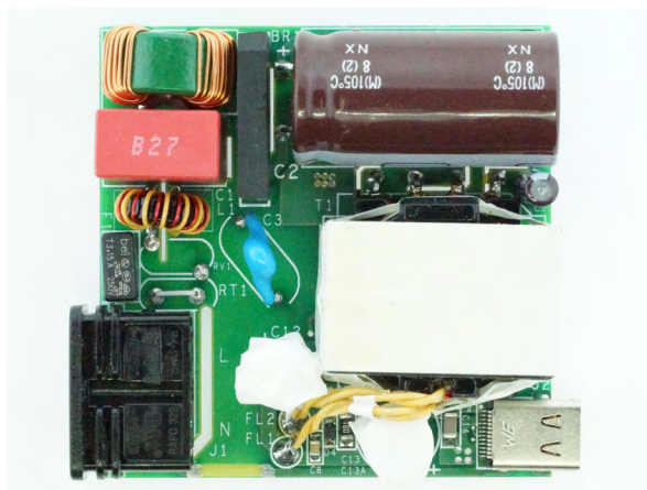
図5 DER-601 - 全負荷範囲で高効率を示す 60 W ワイドレンジの USB PD 充電器 (5 V - 20 V 出力)。InnoSwitch3-CP INN3279C-H215。60 W アダプタ設計—ヒートシンク不要。
