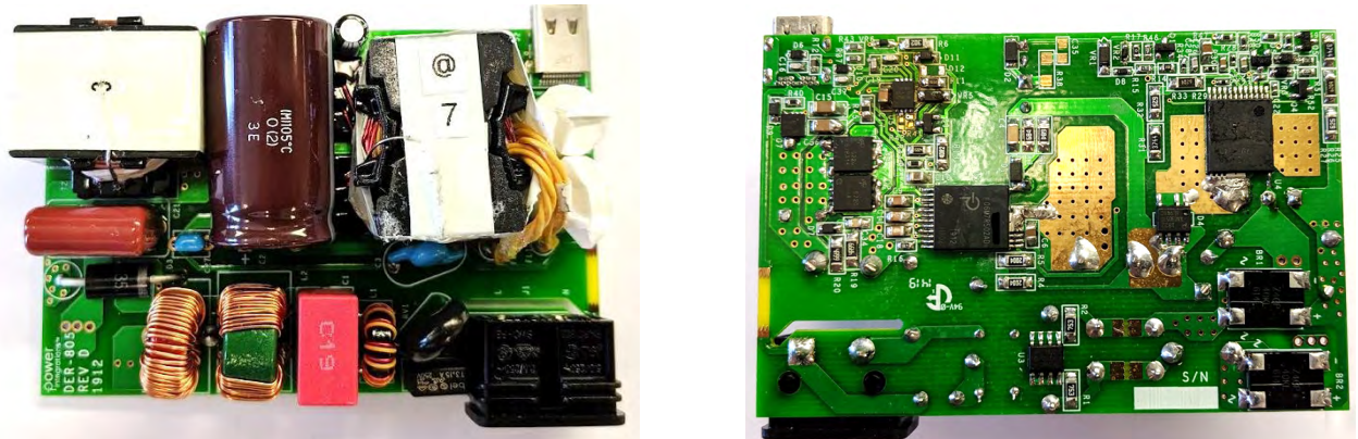
図6 DER-805 - ヒートシンクが不要な 100 W ワイドレンジの USB PD + PPS 充電器 (5 V - 20 V 出力)。InnoSwitch3-Pro INN3370C-H302。
