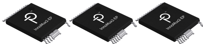
图 4. 左 - 采用InSOP-24B封装的InnoMux2-EP器件 中 - 采用InSOP-T28D封装的InnoMux2-EP器件 右 - 采用InSOP-T28G封装的InnoMux2-EP器件
