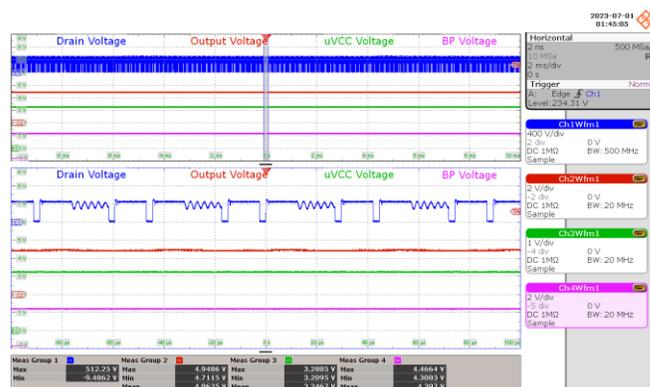
**图101** - 正常工作时的 $uVCC$ 波形
