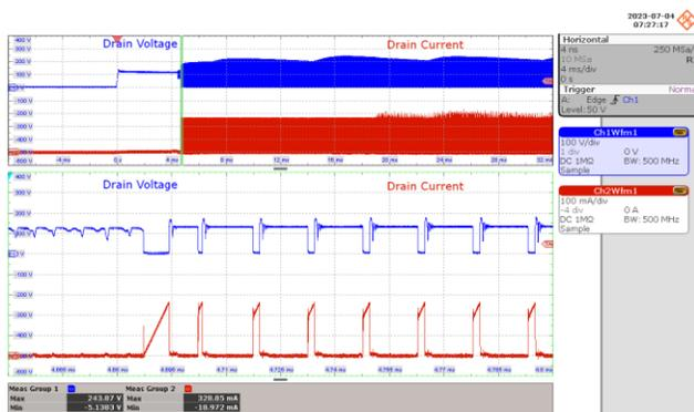
**图36** - 漏极电压和电流波形
