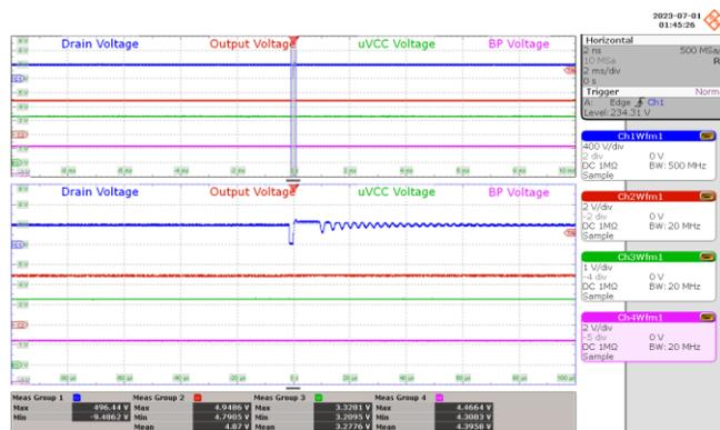
**图99** - 正常工作时的uVcc波形
