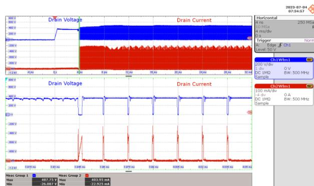
**图39** - 漏极电压和电流波形
