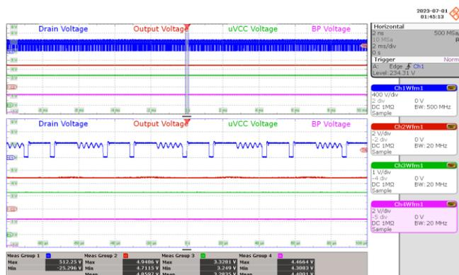
**图97** - 正常工作时的uVcc波形
