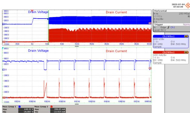
**图38** - 漏极电压和电流波形
