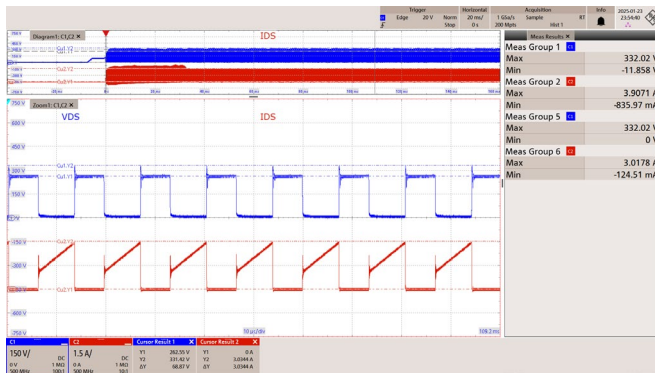
Figure 51 – 85 VAC 60 Hz. CH1: V DS , 150 V / div., 20 ms / div. CH2: I DS , 1.5 A / div., 20 ms / div. Zoom: 10 μs / div. V DS(MAX) = 332 V I DS(MAX) = 3.91 A
