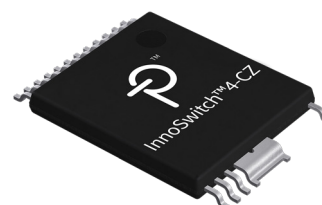
図 2. 高治面距離、安全規格準拠 InSOP-24D パッケージ
