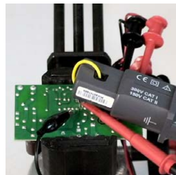
电压探针和电流探针的连接方式
