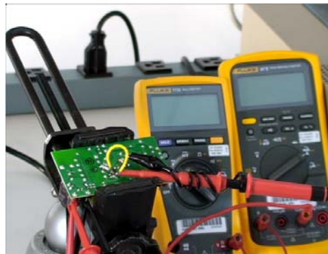
將接地線纏繞在電壓探棒上
