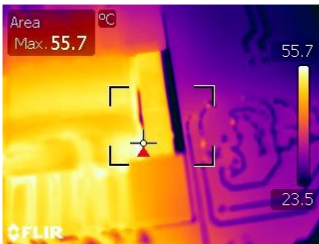
圖 33 – 滿載變壓器 (T1) 熱跡圖，室溫。
